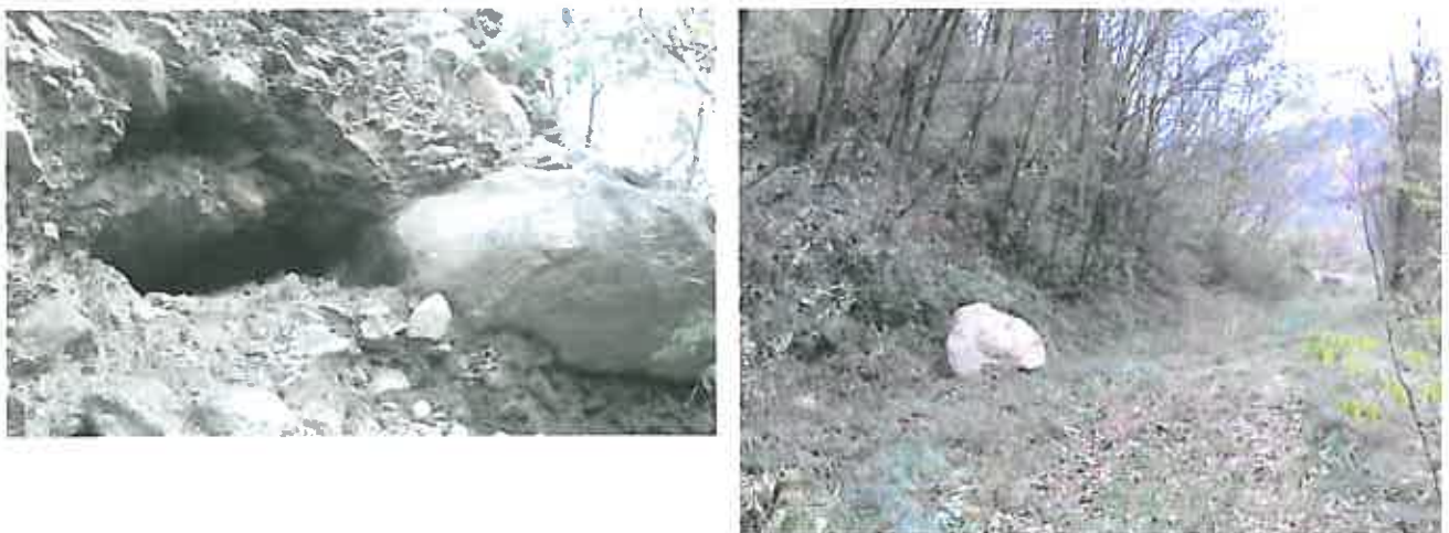
Abb. 9: links: Ausbruch eines instabilen Einzelblocks; rechts: Sturzblock erreicht den geplanten Radweg im Bereich östlich vom Graben
